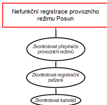
Obr. 19: Lokalizace vadného dílu při poruše Nefunkční registrace provozního režimu Posun
